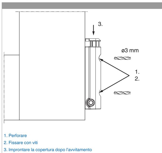
Appoggiare, perforare e avvitare alla battuta l'angolo cerniera ad incasso con fissaggio battuta!
