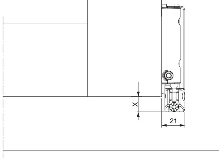
Con l'utilizzo delle coperture l'ingombro si riduce di +1 mm!
