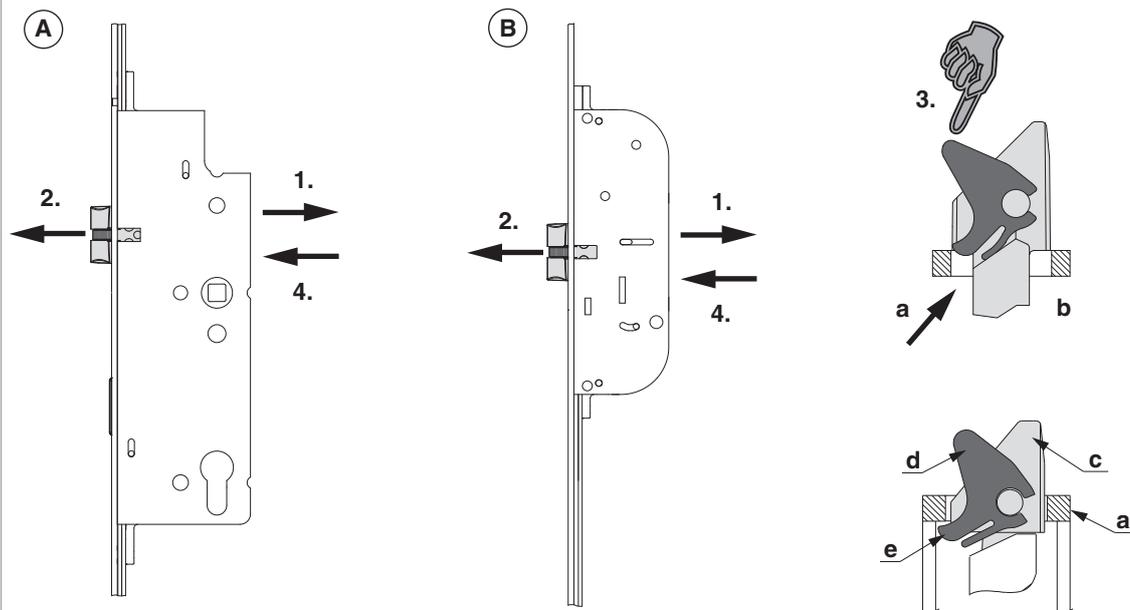
1.) Allentare completamente la vite e spingere lo scrocco in avanti con il cacciavite
