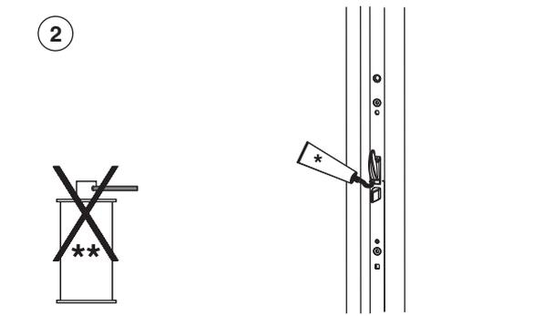
1) La scatola serratura viene fornita con una lubrificazione costante con grassi di alta qualità, di conseguenza **NON** è necessario lubrificarla nuovamente! Lubrificare scrocchi e mandata una volta all'anno!
