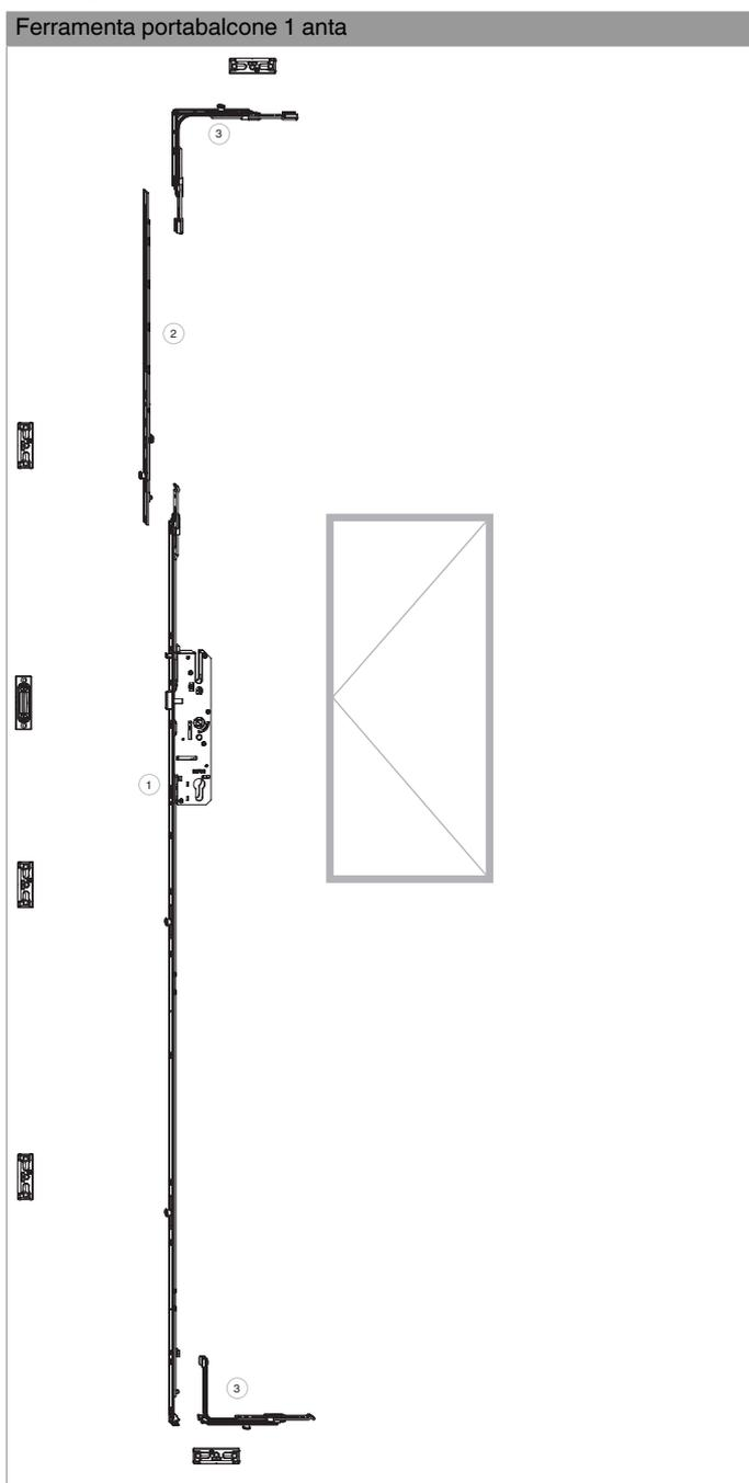
**203837 - Serratura per portafinestra con scrocco con 2
