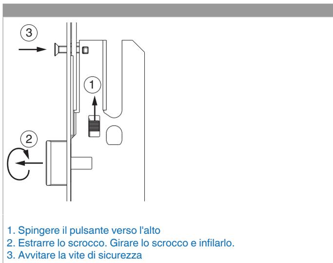
203837 - Serratura per portafinestra con scrocco con 2
