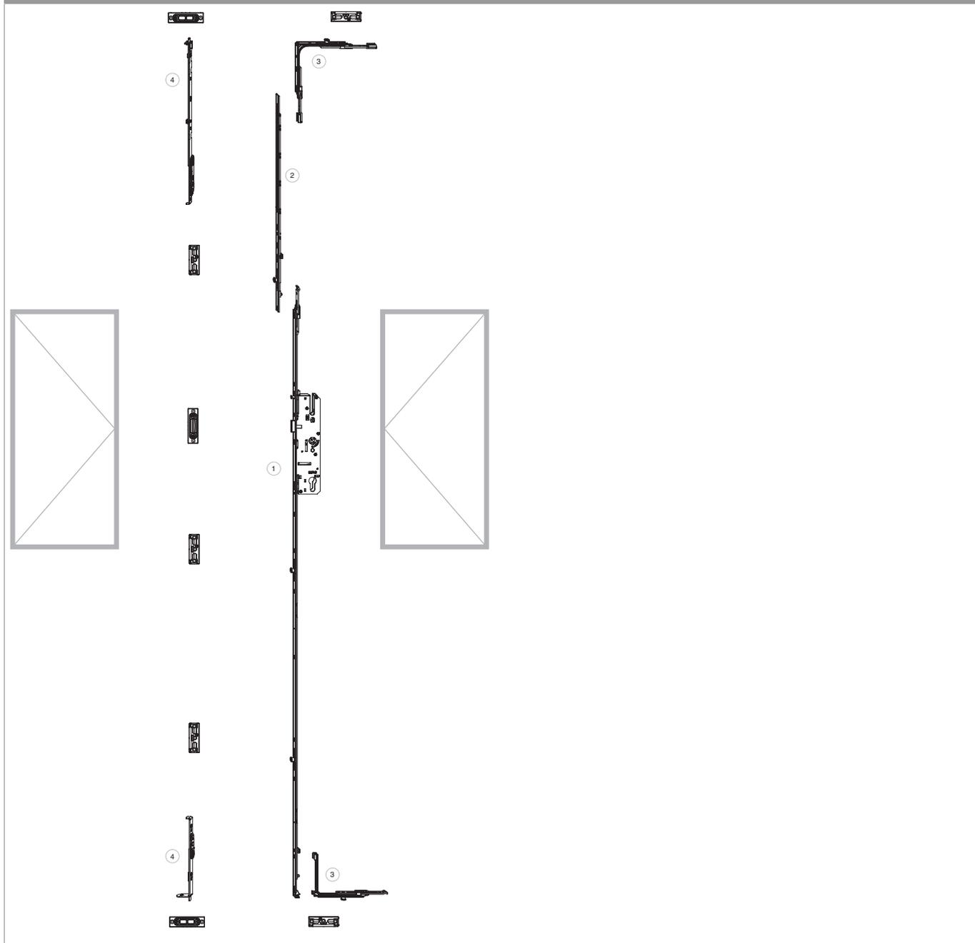
**203837 - Serratura per portafinestra con scrocco con 2
